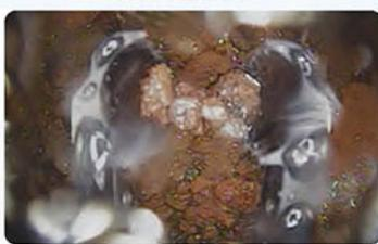
▲2号機原子炉格納容器内部調査にて、小石状等の堆積物に接触している様子。(2019年2月13日実施)
