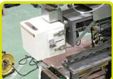
切断に使用するチップソーをカバーで覆い、内部に吸引機も取付けました。
