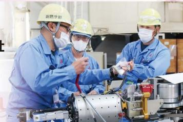
三菱重工業株式会社では、原子力プラントメーカーとして長年培ってきた原子力技術を駆使し、2号機の燃料デブリ試験的取り出しに向けたロボットアームの開発をIRIDの一員として行っています。挿入口から十数メートル先にある燃料デブリ取
