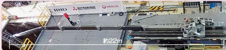
▲最大伸長時(約22m)のロボットアーム。
