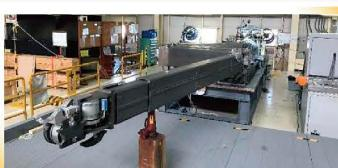
◆今後予定されている2号機原子炉格納容器内の燃料デブリの試験的取り出し。アーム型の遠隔操作ロボットで、原子炉格納容器内の障害物の除去や内部調査、燃料デブリの試験的取り出しを進める予定です。
