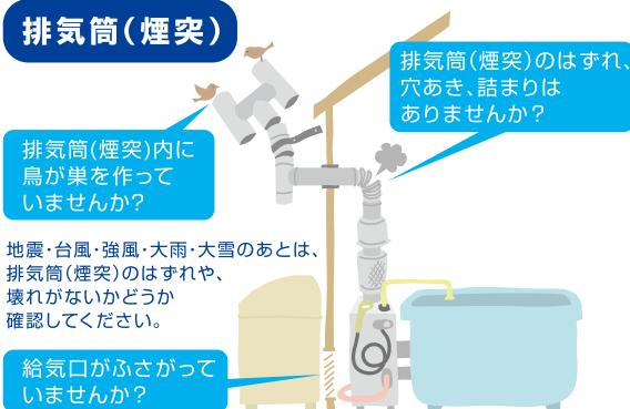
いずれも放置しておくと、ガス機器が正常に燃焼しない、あるいは排気が室内に流入するなどして、一酸化炭素中毒の原因となるおそれがあります。
