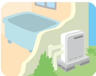
機器を屋外に設置、煙突などの給排気設備は必要なく、最も安全な機器です。
