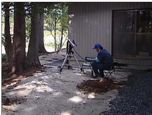
除染後の状態調査（指向性モニタリング）
