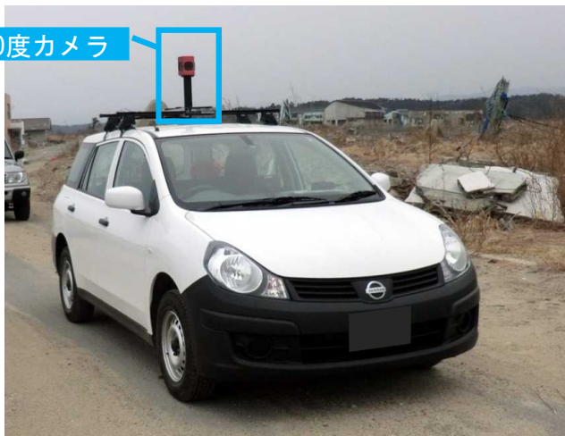
車両による走行モニタリング状況
