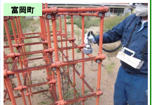
【③残置物の表面汚染密度測定】
