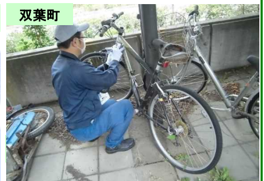
【③残置物の表面汚染密度測定】
