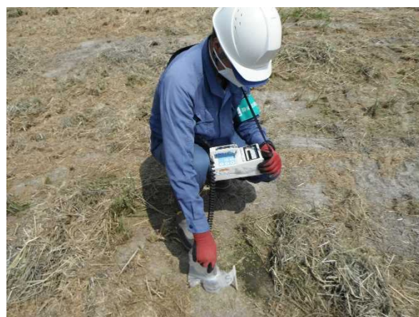
【表面汚染密度の測定状況】
