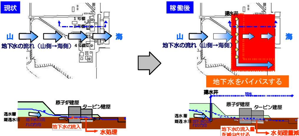
地下水は、山側から海側に向かって流れております。その地下水の一部が建屋内に流入し、汚染水が増加しています。建屋内へ流入する地下水を少なくすることを目的に、**建屋よりも上流で井戸を掘り、揚水して、地下水の流路を変更する「地下水バイパス」**を計画しています。
