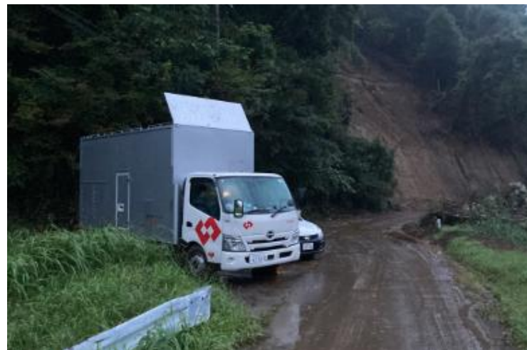
＜発電機車による応急送電作業＞
