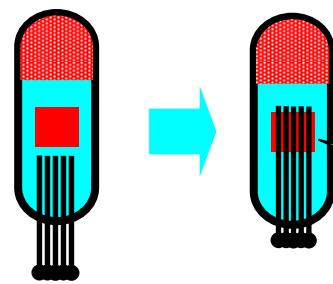
停止後も崩壊が発生するため冷却要
