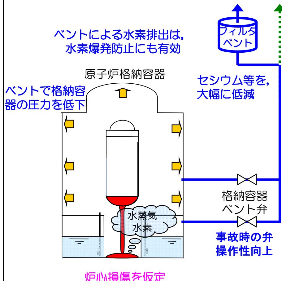
炉心損傷を仮定
