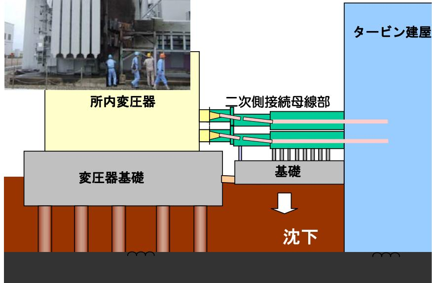
変圧器及び関連設備の基礎部の不等沈下により火災が発生、屋外消火設備の損傷により、消火活動に支障をきたした。
