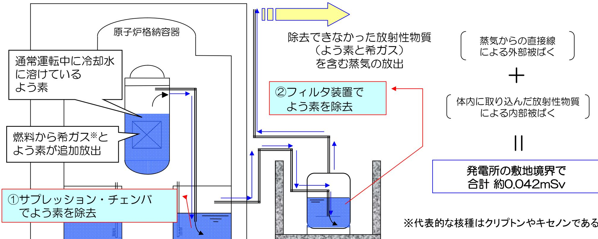
(炉心損傷しても、敷地外の土壤汚染を大幅に抑制するためのベント)
