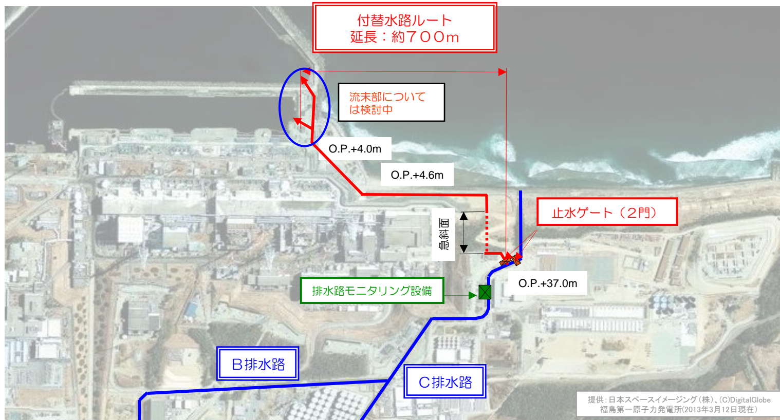
【側溝ルート変更概略図】
