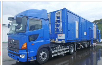
代替熱交換設備
