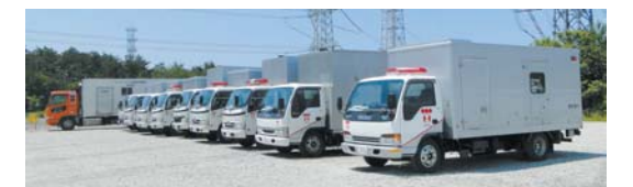
新たに配備した電源車
