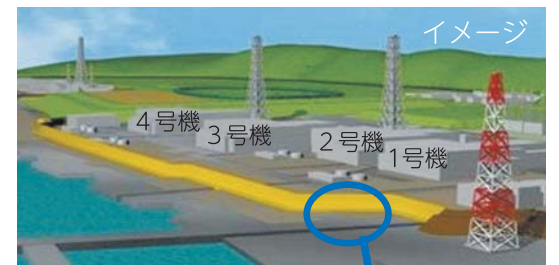
敷地海側に設置する防波堤(堤防) (25年6月完成予定)
