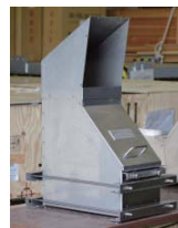
触媒により水素と酸素を結合させて水に戻す水素再結合装置
