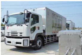
ガスタービン発電機車
