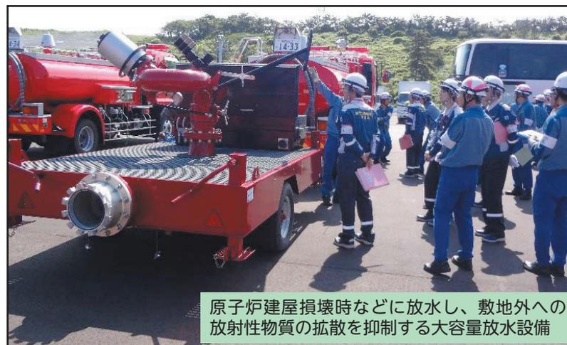
原子炉建屋損壊時などに放水し、敷地外への放射性物質の拡散を抑制する大容量放水設備
