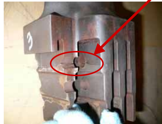
フォーク損傷部(119枚目)
