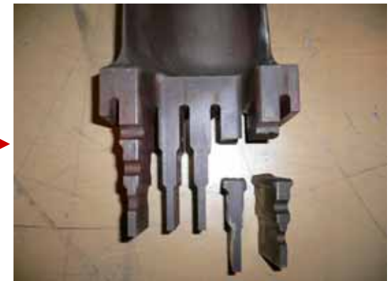
フォーク損傷部(119枚目)
