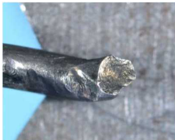
レーシングワイヤ破断面外観
