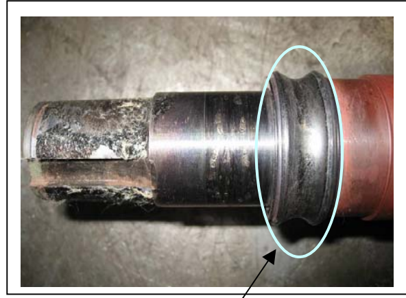
損傷していた軸受部
