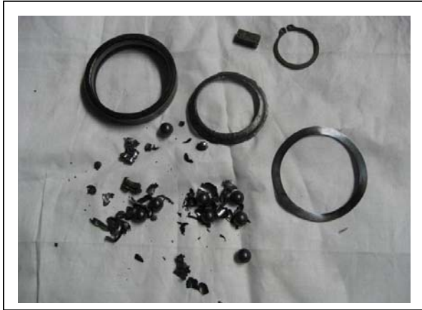
損傷していた軸受の部品
