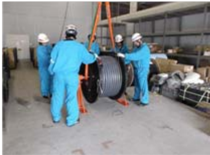
上の写真は、ケーブルを引き出すためにドラムを吊り上げた後、ケーブル引き出し、布設する訓練を行っている様子です（平成25年7月19日実施）。
