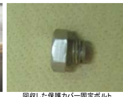
回収した保護カバー固定ボルト
