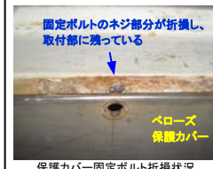
保護カバー固定ボルト折損状況
