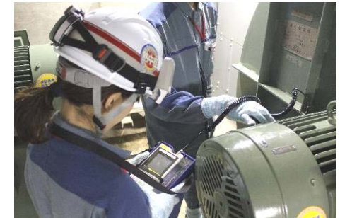
精密機器を使用した振動測定
