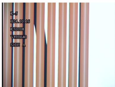
柏崎刈羽原子力発電所5号機で曲がり確認された燃料集合体のウォータ・ロッドの状況
