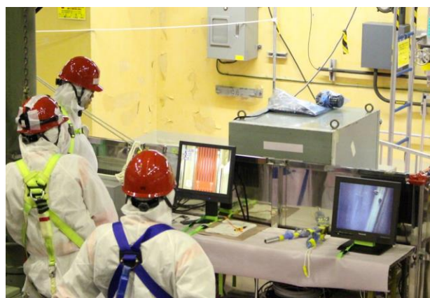
水中カメラで撮影した燃料集合体の状態をモニターで確認
