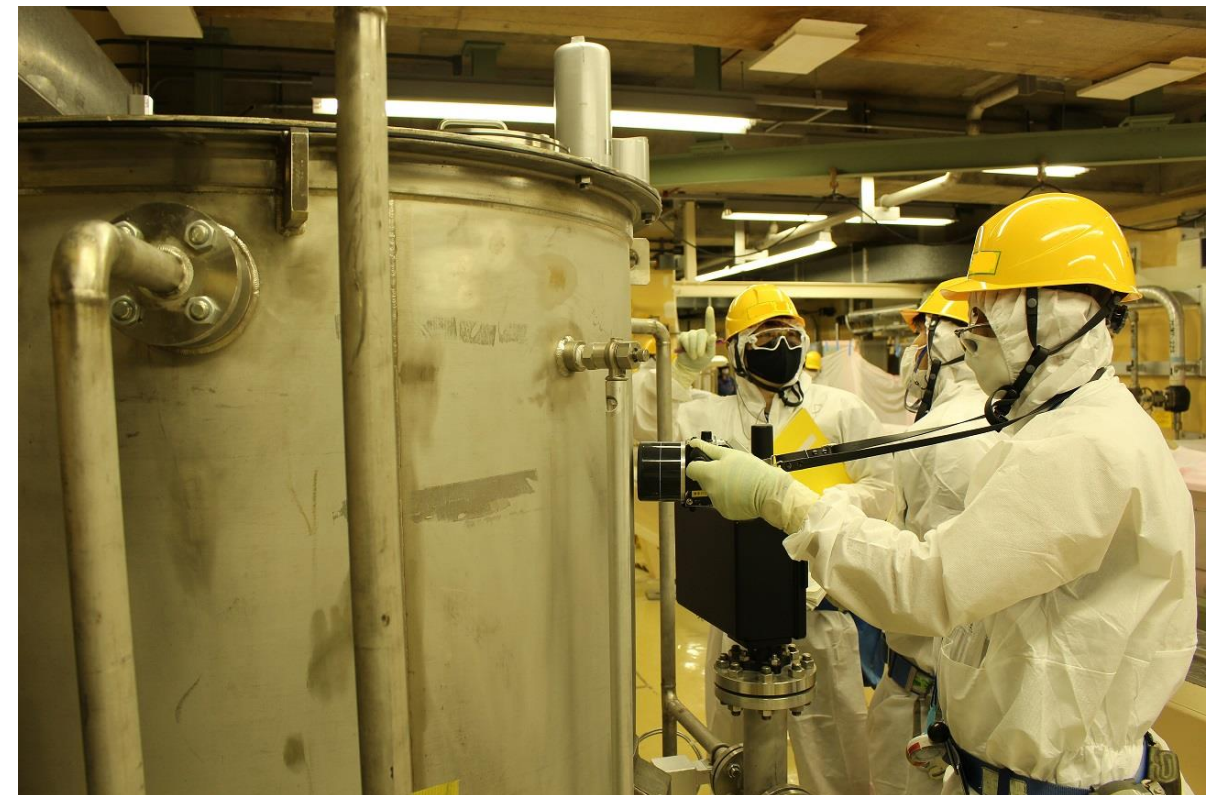
駆動水供給タンクの表面線量を測定している様子
