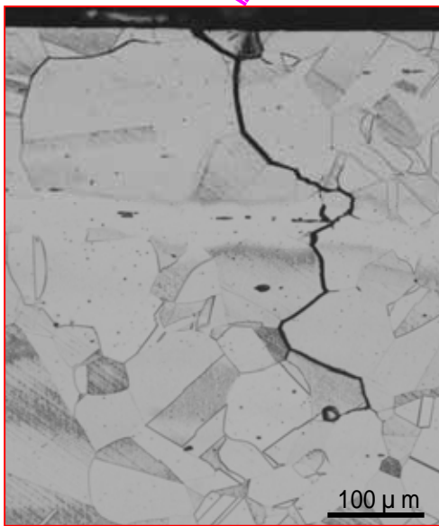
粒界に沿って発生したひび(断面図)
