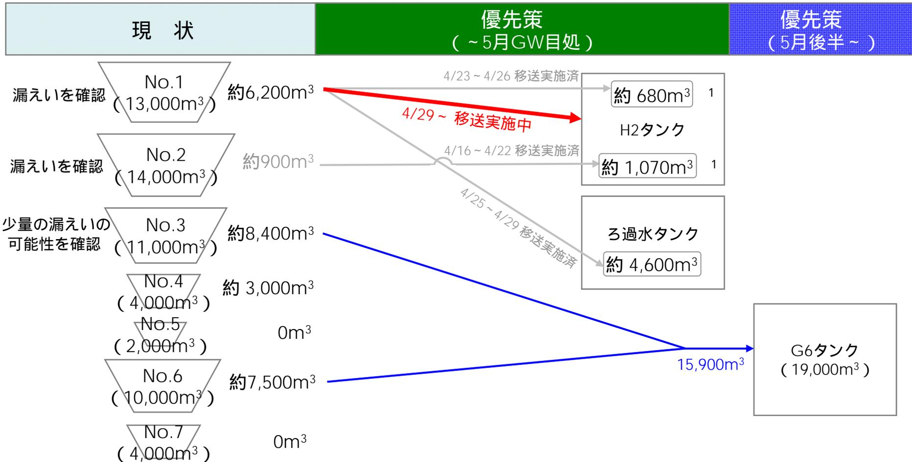
1 移送量は、H2エリアタンク水位計の実績から確認。
