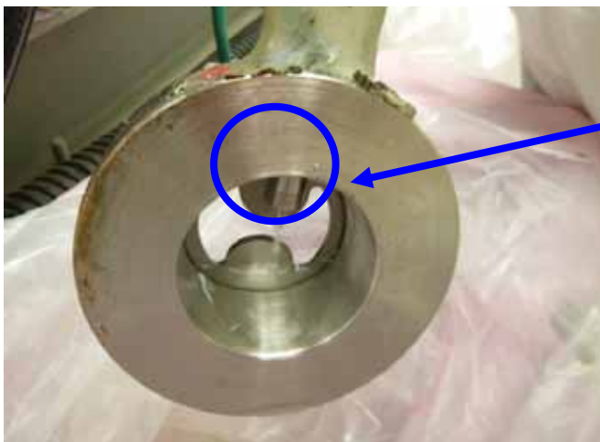
塩酸注入箇所下流側配管内 （材料はSUS316L） 有意な腐食は確認されず
