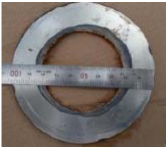
⑦供給ポンプ1出口配管 ガスケット型犠牲陽極
