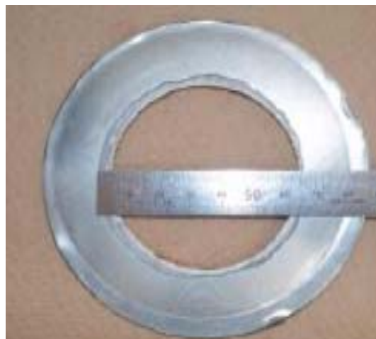
②スラリー移送ポンプ出口配管 ガスケット型犠牲陽極
