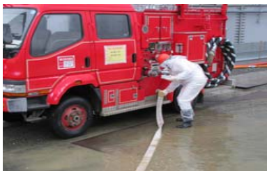
消防車へホースを接続する様子
