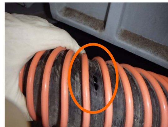
確認のため、ホースを曲げて当該箇所を拡大させた状態
