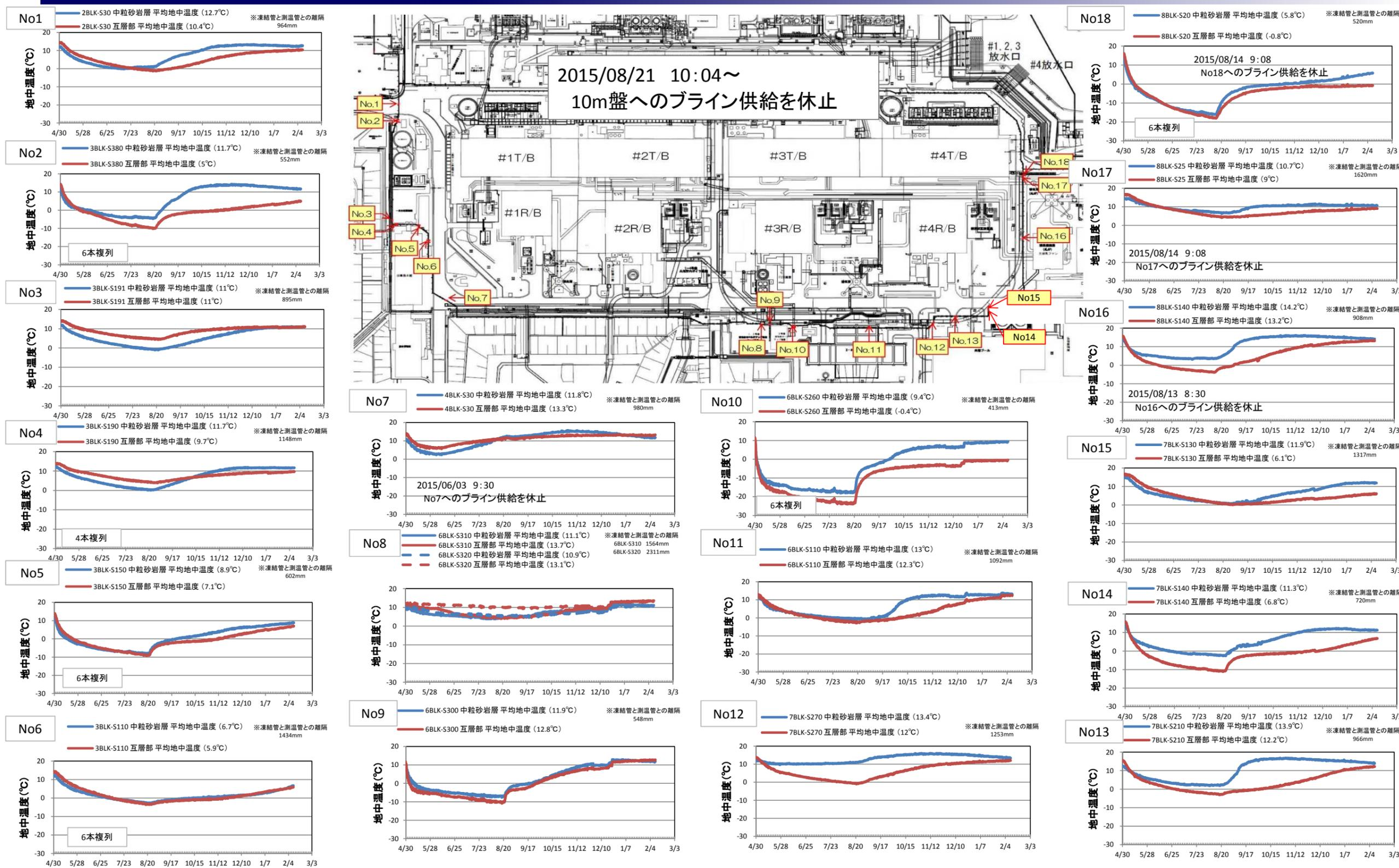
注1) 中粒砂岩層の平均地中温度: 地表~GL-2mと第1泥質部境界付近を除く1mピッチで計測されている測温管温度の平均値
