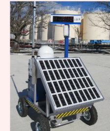
線量率モニタの設置状況
