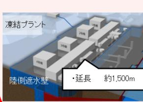
建屋への地下水流入を抑制するため、建屋を囲む陸側遮水壁の設置を計画。2016年3月より海側及び山側の一部、2016年6月より山側の95%の範囲の凍結を開始。残りの箇所についても段階的に凍結を進め、2017年8月に全ての箇所の凍結を開始。
