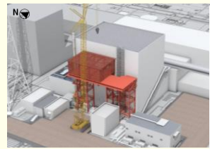
遠隔重機による屋根保護層撤去状況
