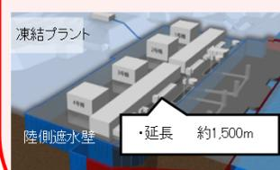
建屋への地下水流入を抑制するため、建屋を囲む陸側遮水壁の設置を計画。2016年3月より海側及び山側の一部、2016年6月より山側の95%の範囲の凍結を開始。残りの箇所についても段階的に凍結を進め、2017年8月に全ての箇所の凍結を開始。
