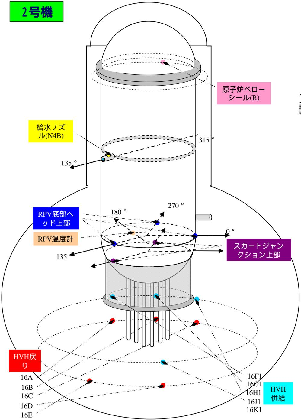
2号機 原子炉圧力容器まわり温度 (6/21 ~ 9/25)
