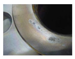
スラリー移送ポンプ出口配管(拡大)フランジシール面に**すき間食有り**
