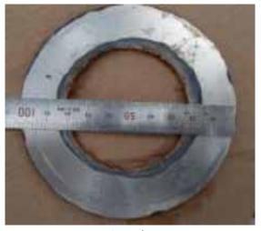
供給ポンプ1出口配管 ガスケット型犠牲陽極
