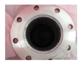
フランジ シート面に 腐食なし
