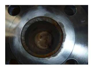
供給ポンプ1A出口配管 フランジシール面に**すき間腐食有り**
