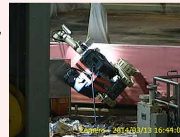
遠隔操作ロボット転倒状況
