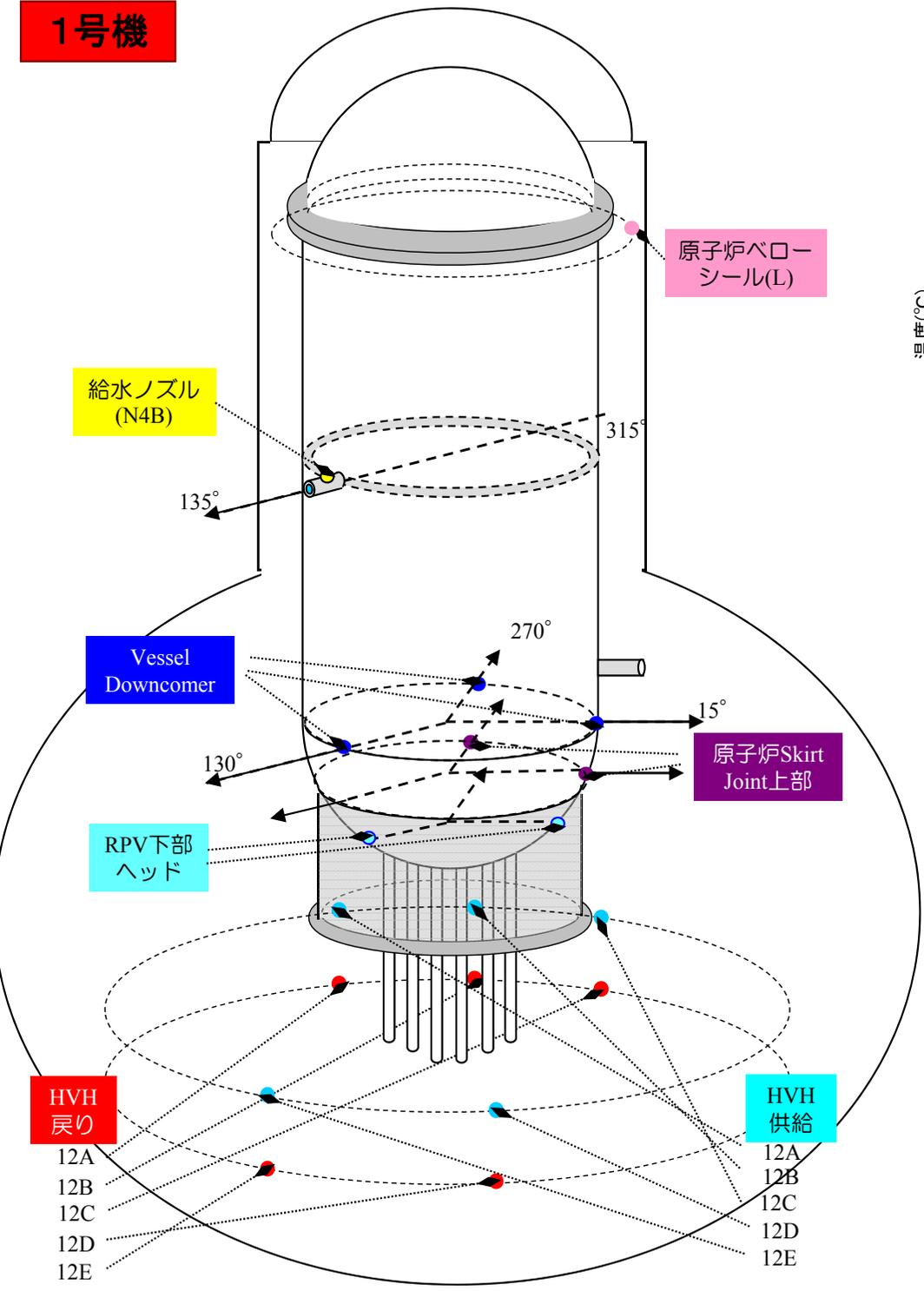
1号機 原子炉压力容器まわり温度(4/26~7/30)
