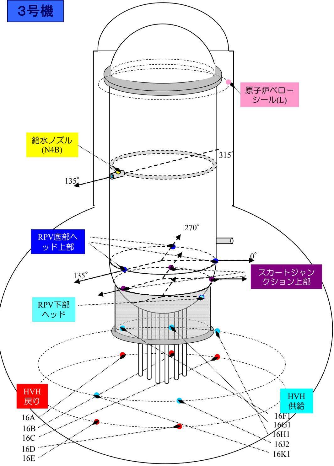
3号機 原子炉压力容器まわり温度(4/26~7/30)
