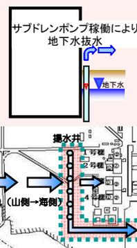
サブドレン水汲み上げによる地下水位低下に向け、サブドレン他水処理施設の安定稼働の確認のための試験を実施。浄化により地下水バイパスの運用目標を下回ること、その他γ核種が検出されないことを確認。サブドレン水を汲み上げることによる地下水流入の抑制
