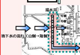
地下水バイパスにより、建屋付近の地下水位を低下させ、建屋への地下水流入を抑制
