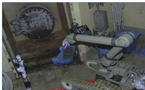
(溝部のスチーム洗浄水回収作業)
