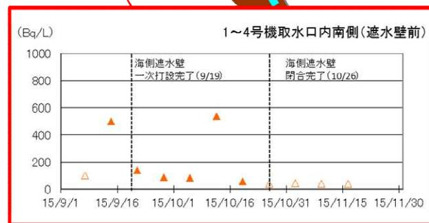
※1～4号機取水口内南側（遮水壁前）は、最後に遮水壁閉合を実施した箇所。
