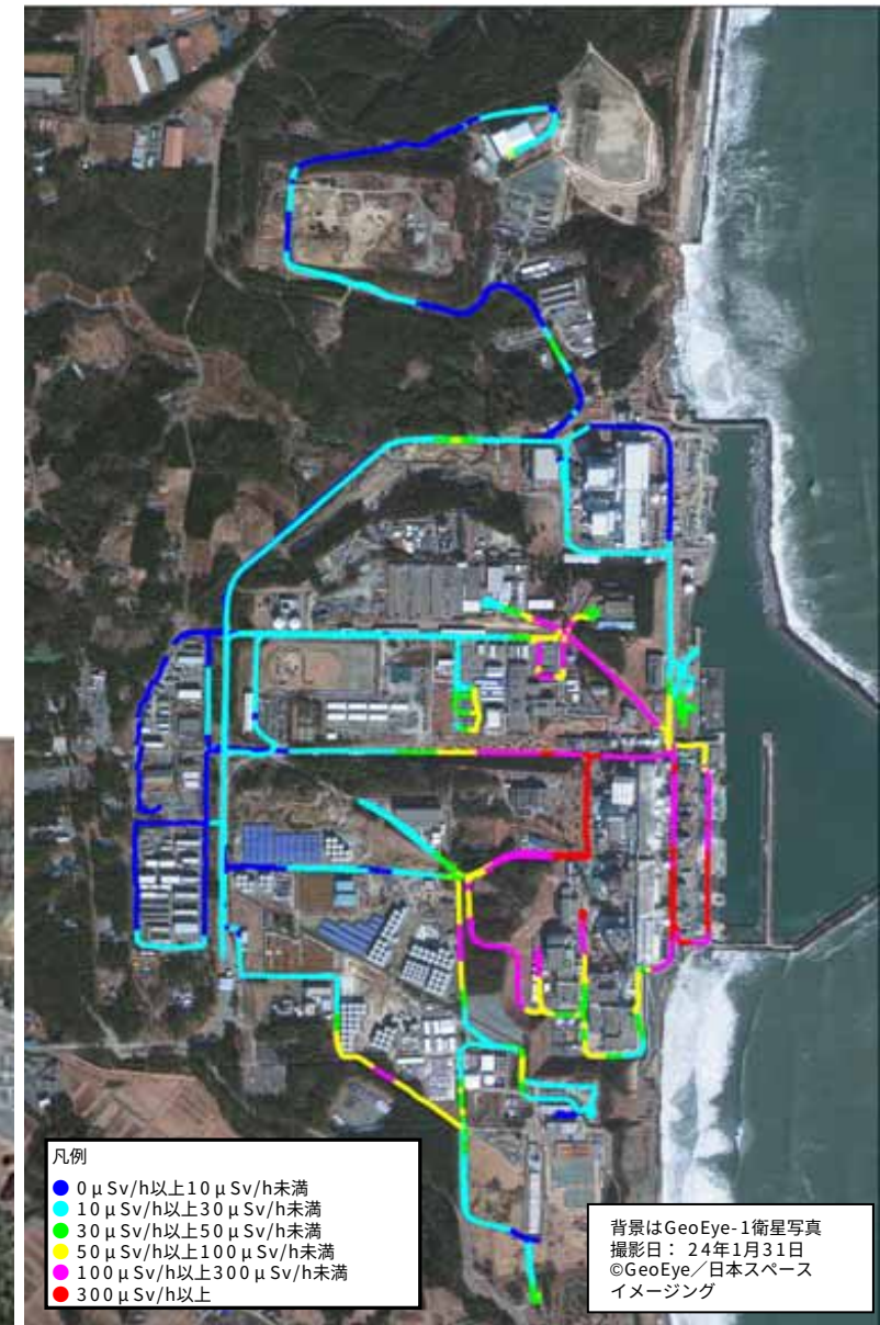
構内の走行サーベイ結果（H24.5.9測定）
