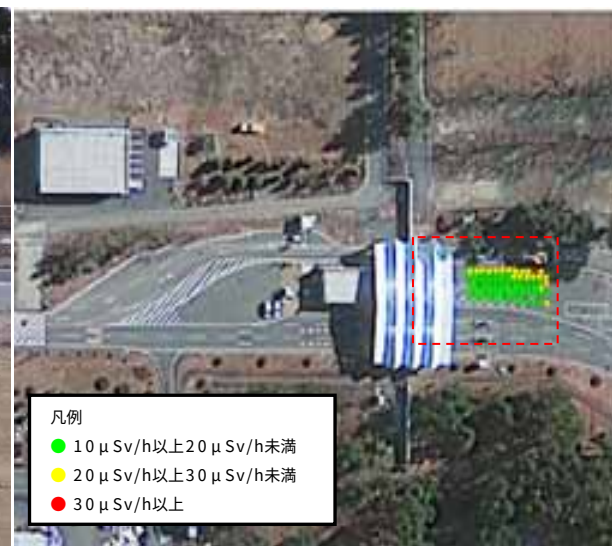
正門の除染実証試験エリアの歩行サーベイ結果（H24.5.9測定）
