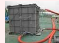
海水循環型浄化装置
