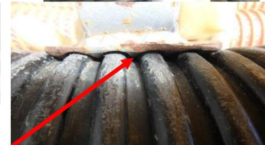
締込用バンドの溝とホース外面の挟み込み状況
