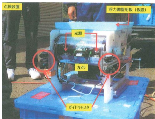
【タンク内面目視点検用水中ビークル】
