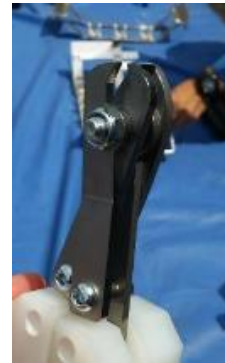
PDカッターを改良し、 1本の工具で切断しつつ把持
